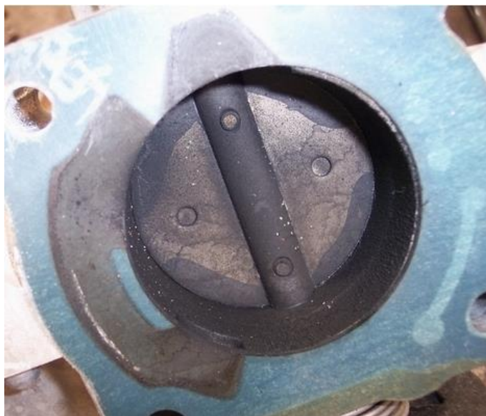
图 4.7 发动机节气门积碳
